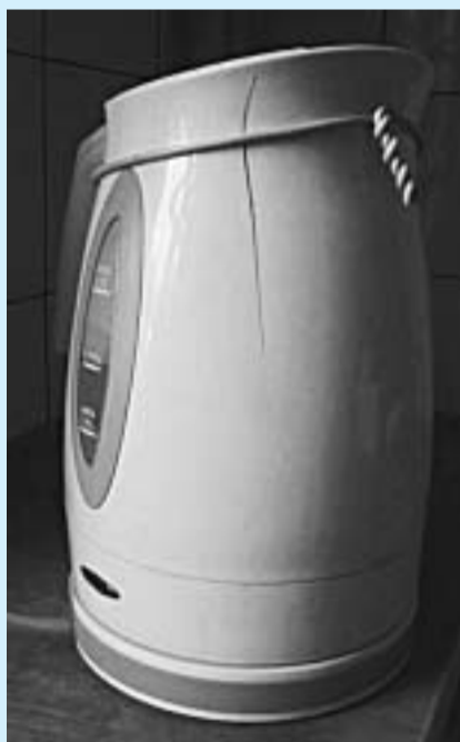
Merwürdige Risse? Elektrikerdraht hilft! (vgl. QUAVIER 76, S. 14).
